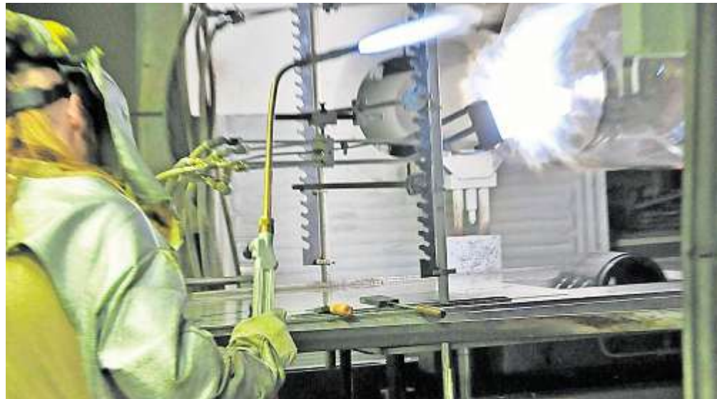
Obwohl beim Quarzglas Temperaturen bis zu 1200 Grad Celsius herrschen, ist immer noch ein großer Teil der Arbeit Hand- und Mundarbeit. Fotos: Gerd Dolge
